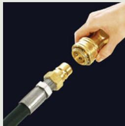
套筒内的滚珠锁扣部位为自由状态时插塞为插入状态。此时，套筒和插塞的阀门利用弹簧的复元力固定在底座位置，以防止流体的流出。
